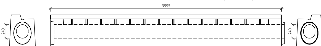
BEST TROUBA S PRŮBĚŽNÝM ŠTĚRBINOVÝM ŽLABEM, ROVNÁ 20/26-26, OBRUBNÍK 7 cm (PROFIL PRAVÝ)
