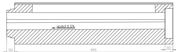
BEST MALÁ TROUBA S PRŮBĚŽNÝM ŠTĚRBINOVÝM ŽLABEM, SPÁDOVÉ JÁDRO 105/110
