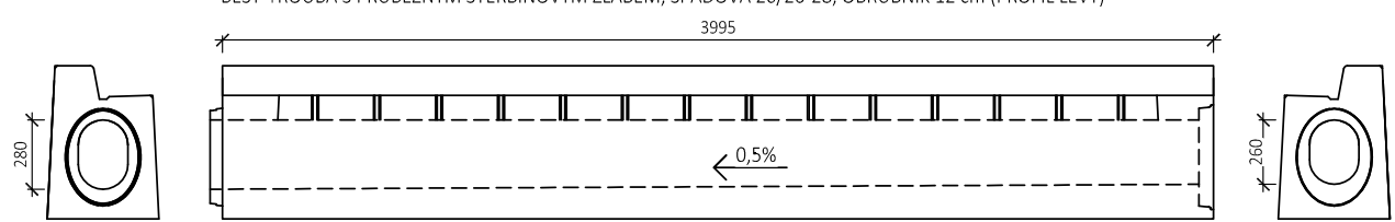
BEST TROUBA S PRŮBĚŽNÝM ŠTĚRBINOVÝM ŽLABEM, SPÁDOVÁ 20/24-26, OBRUBNÍK 12 cm (PROFIL LEVÝ)
