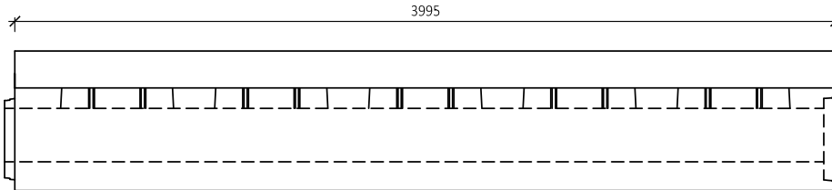
BEST TROUBA S PŘERUŠOVANÝM ŠTĚRBINOVÝM ŽLABEM, ROVNÁ 20/28-28, OBRUBNÍK 18 cm (PROFIL LEVÝ)
