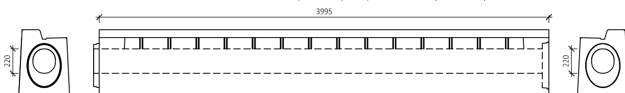
BEST TROUBA S PRŮBĚŽNÝM ŠTĚRBINOVÝM ŽLABEM, ROVNÁ 20/24-24, OBRUBNÍK 7 cm (PROFIL LEVÝ)
