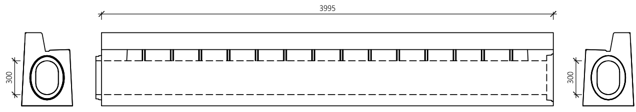
BEST TROUBA S PRŮBĚŽNÝM ŠTĚRBINOVÝM ŽLABEM, SPÁDOVÁ 20/28-30, OBRUBNÍK 15 cm (PROFIL LEVÝ)
