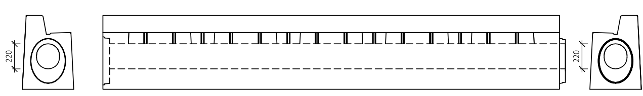
BEST TROUBA S PŘERUŠOVANÝM ŠTĚRBINOVÝM ŽLABEM, ROVNÁ 20/24-24, OBRUBNÍK 15 cm (PROFIL PRAVÝ)
