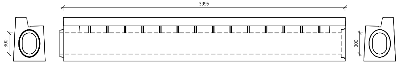
BEST TROUBA S PRŮBĚŽNÝM ŠTĚRBINOVÝM ŽLABEM, SPÁDOVÁ 20/28-30, OBRUBNÍK 12 cm (PROFIL LEVÝ)
