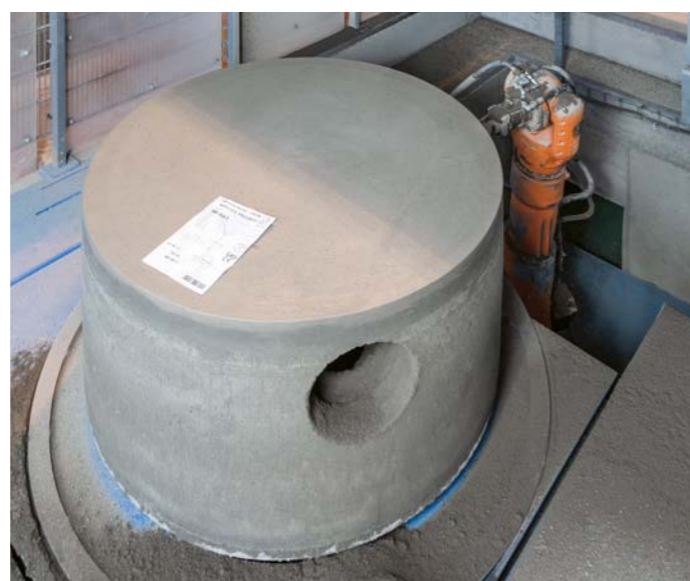
Samotné frézování kynety a vstupů do šachty proběhne v řádu jednotek minut
