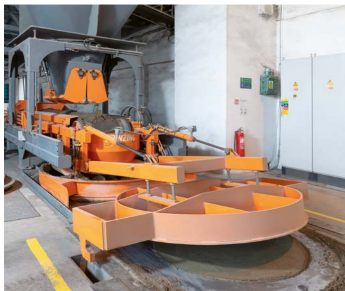
Proces výroby polotovaru systémem vibrolisování
